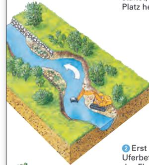
2 Erst einmal werden die Uferbefestigungen entfernt, das Flussbett verbreitert und die Ufer abgeflacht.
