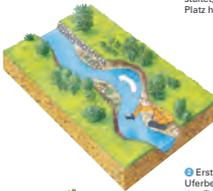
2 Erst einmal werden die Uferbefestigungen entfernt, das Flussbett verbreitert und die Ufer abgeflacht.
